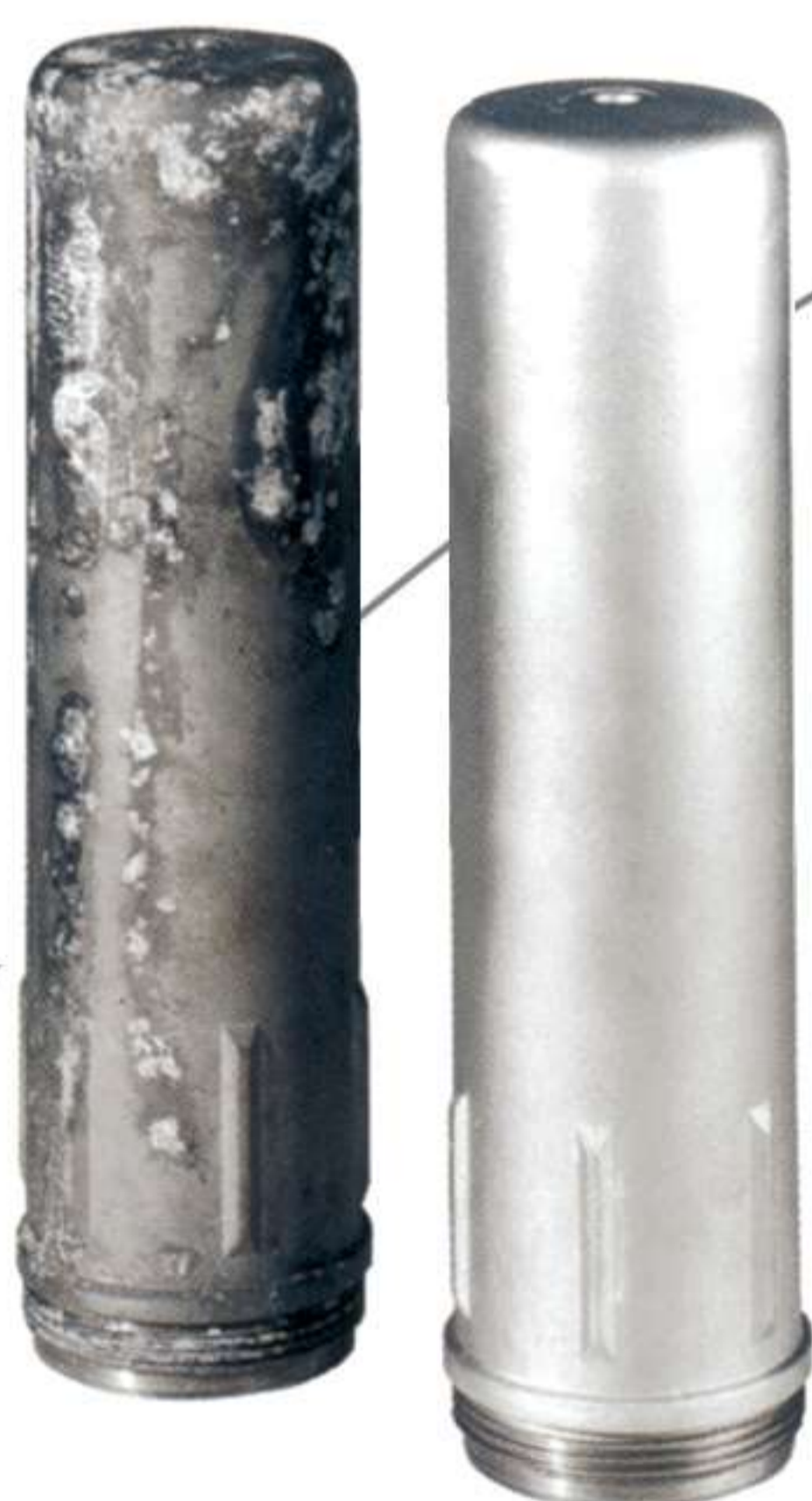
دو نوع هوزینگ آلومینیومی معمولی و آلوکرم شده بعد از تست پاشش محلول نمک طبق DIN 50021 SS < ۲۵۰ ساعت
